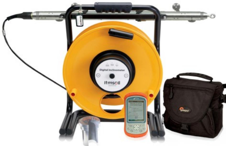
Цифровой наклонный скважинный инклинометр используется для измерения смещений в наклонных скважинах.
