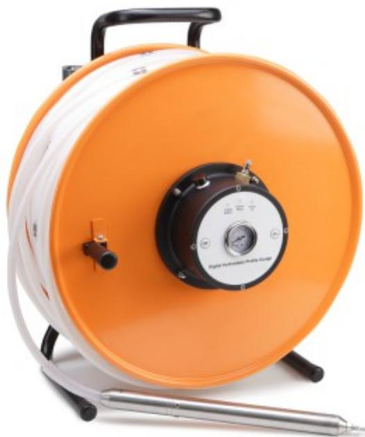
Портативный цифровой измеритель осадок используется для контроля вертикальных смещений под массивными конструкциями, доступ к поверхностям которых невозможен.
