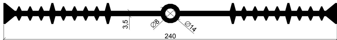
Гидротехническая шпонка ТХП из пластифицированного ПВХ. Предназначена для уплотнения "холодных" и деформационных швов в бетонных и железобетонных конструкциях. Воспринимаемые перемещения: на сжатие - до 8 мм, на растяжение - до 12 мм, на срез - до 8 мм, без возникновения внутренних напряжений. При монтаже шпонка устанавливается в тело железобетонной конструкции с креплением к арматурному каркасу. Рекомендуемая ширина обустраиваемого зазора деформационного шва - 10-15 мм.
